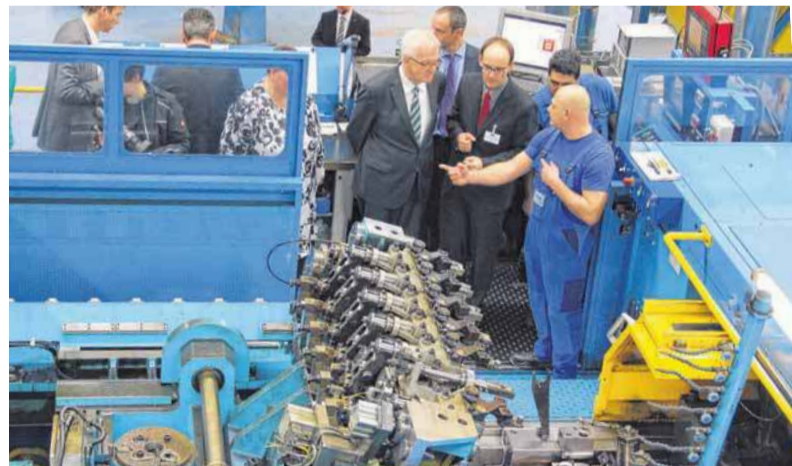
Mit dieser Maschine mit 900 Tonnen Pressdruck und anderen werden die 1,2 Millionen Teile, die Hewi täglich produziert, kalt gepresst.
